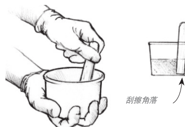
图3 在更低温度下充分搅拌树脂与硬化剂，持续至少一分钟。
