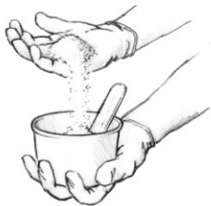
图5 加入少量填料搅拌，直至达到所需的稠度。
