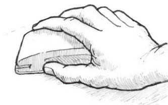
图32 用砂纸打磨，使其光滑。
