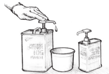
图2 分配适当比例的树脂和硬化剂。 使用微型泵—针对每个全泵冲程泵送的硬化剂，在全泵冲程下泵送树脂
