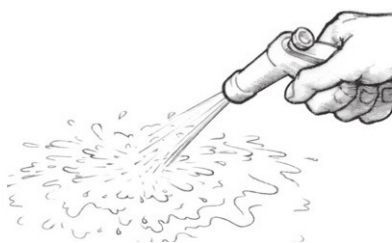
图33 打磨后，用清水冲洗表面。
