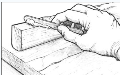
Kuva 10 Levitä saostettua epoksia toiselle liimattavista pinnoista.
