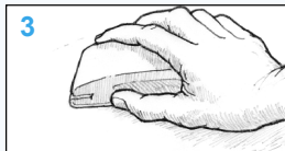
Σχήμα 8 Τρίψτε τις μη πορώδεις επιφάνειες με γυαλόχαρτο. Προσδώστε τους τραχιά υφή για τη μηχανική προσκόλληση της ρητίνης.
