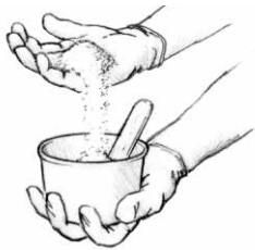
그림 5 원하는 균일성의 농도에 도달할 때까지 소량의 필러 한 줌을 섞어 휘젓습니다.
