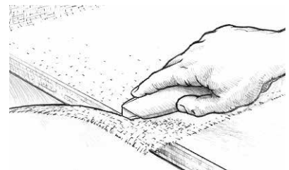
그림 26 에폭시가 겹쳐진 후에 남은 천을 잘라냅니다.
