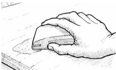
그림 8 비 다공성 표면을 샌딩합니다. 에폭시를 고정하기 위한 결을 만듭니다.
