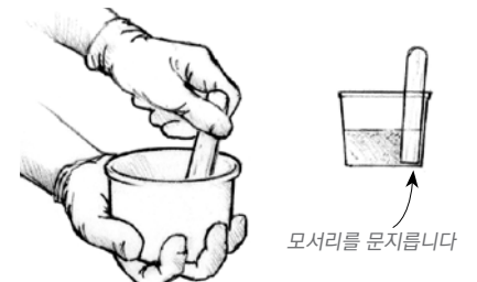
그림 3 수지와 경화제를 충분히 뒤섞습니다. - 최소 1분간, 더 낮은 온도에서는 더 오래 실시합니다.
