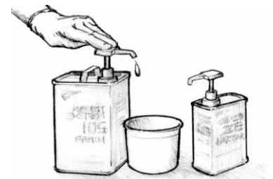
그림 2 적절한 비율의 수지와 경화제를 정량 토출합니다.
