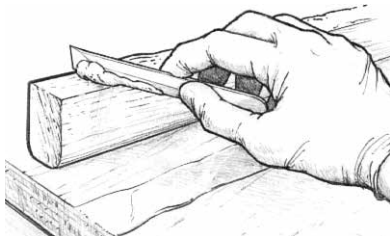
그림 10 농축 에폭시를 접합면 중 하나에 도포합니다.
