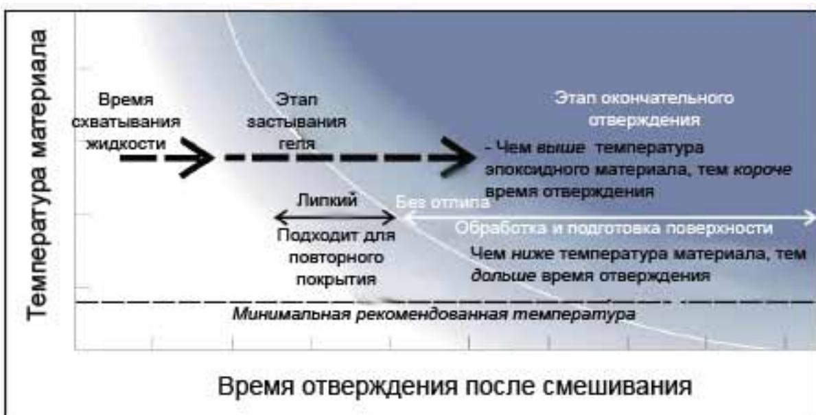
**Рис.1.** По мере отверждения, смешанная эпоксидная смола переходит из жидкого состояния в состояние геля, а затем – в твердое.
