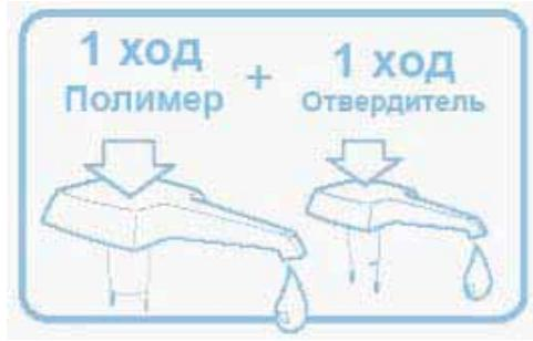
Мини-насосы - один полный ход насоса смолы на один полный ход насоса отвердителя дают правильную пропорцию.
