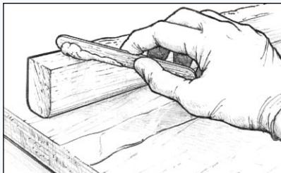
**Slika 10** Nanesite ugušen epoksid na jednu površinu
