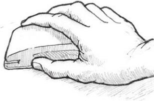
Figura 32 Lijar hasta alcanzar un acabado liso.
