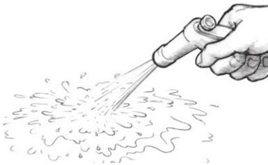
Figura 33 Enjuague la superficie con agua fresca después de lijar.
