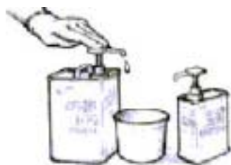
图2. 分配树脂和固化剂合适比例
