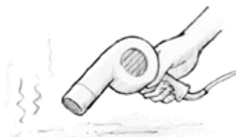
图7 使用加热器快速干燥表面
