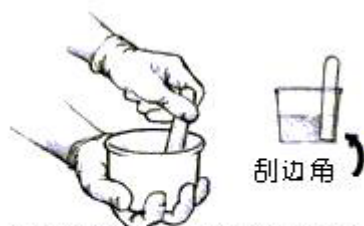
图3。在低温连续、充分搅拌树脂和固化剂至少一分钟。
